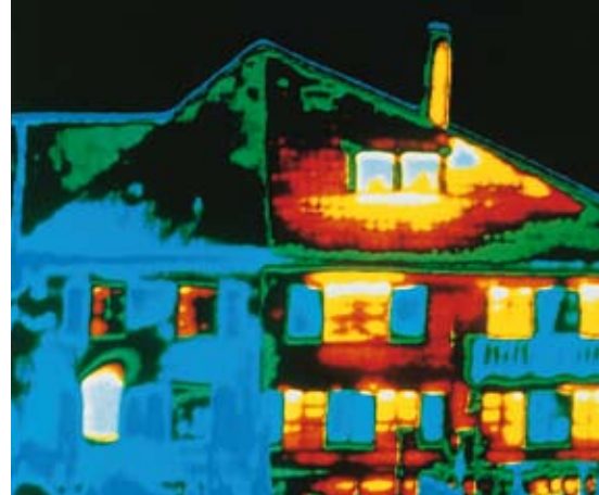
Une photo thermique d'un immeuble permet de déceler les travaux à effectuer en priorité en matière d'isolation. (Photo : BASF)
